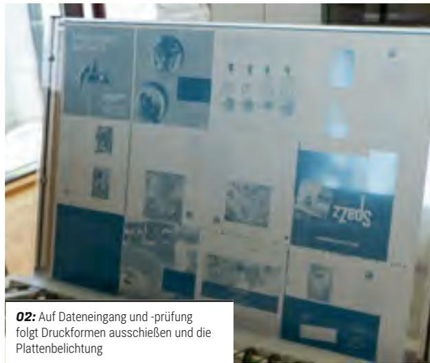
02: Auf Dateneingang und -prüfung folgt Druckformen ausschießen und die Plattenbelichtung
