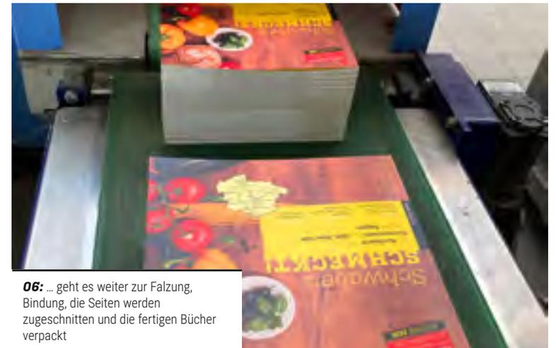
06: ... geht es weiter zur Falzung, Bindung, die Seiten werden zugeschnitten und die fertigen Bücher verpackt
